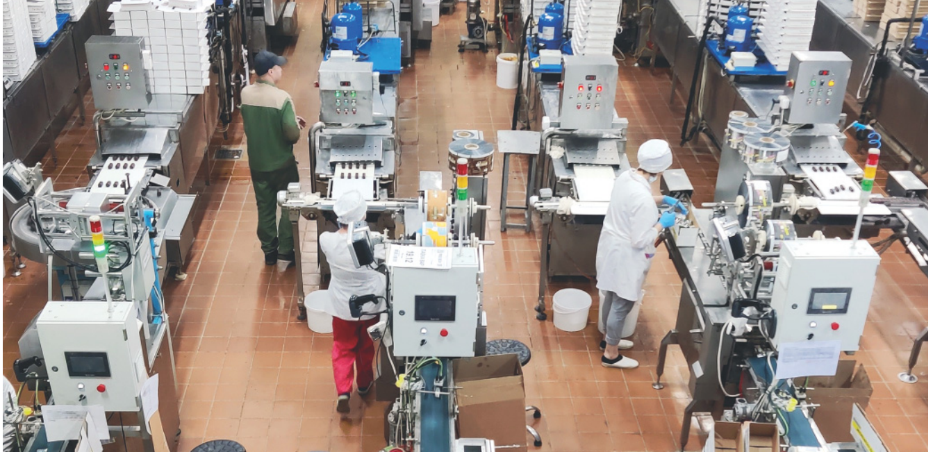
РИСУНОК 3 Применение светосигнальных колонн на предприятии «РостАгроКомплекс»
