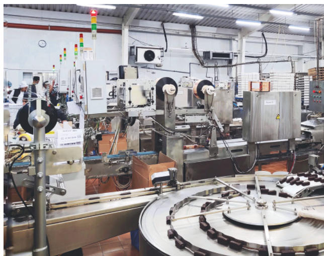
РИСУНОК 1 Светосигнальные колонны MEYERTEC на технологической линии
