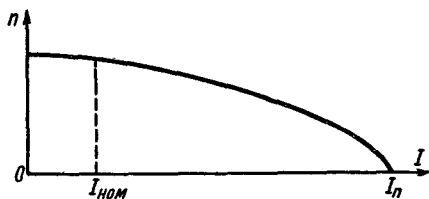
Рис. 12-20. Зависимость между скоростью и током, потребляемым двигателем от сети
