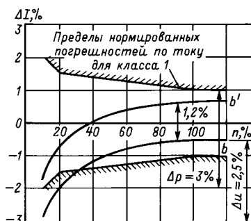
Рис. 5.26. Зависимость погрешности по току \Delta I_{\%} от изменения первичного тока с корректировкой числа витков ( \delta' ) и без нее ( \delta )
