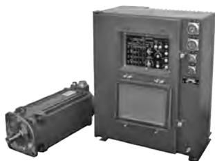
Регулируемый электропривод типа ЭСД1
