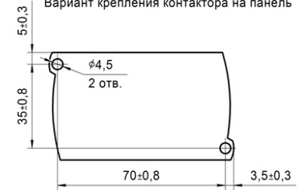
Вид снизу Вариант крепления контактора на панель
