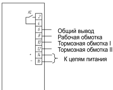
Рисунок 3 — Схема электрическая подключения реле типов PCT 23-1, PCT 23-2
