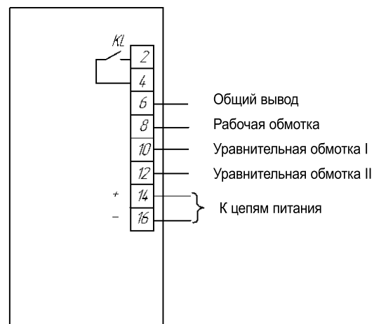
Рисунок 2 – Схема электрической подключения реле типа PCT 15.
