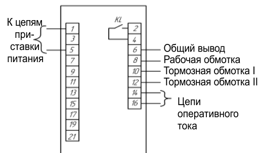
Рисунок 5 — Схема электрическая подключения реле типа PCT 23-6.
