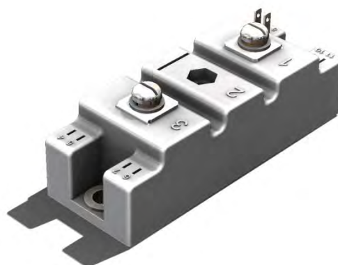
Рис. А.4 корпус П1Д, П1ДП (потенциал на подложку) габаритные размеры: 94x34x35 мм
