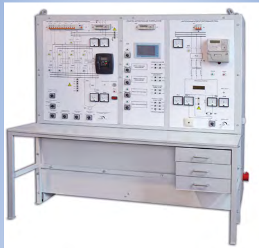
Стенд является базой для начального уровня понимания концепции промышленной автоматизации. На стенде реализована конфигурация, включающая в себя цифровые и аналоговые входы и выходы.
