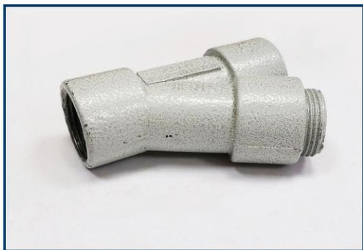
Фитинговые разделительные соединения с заливкой компаундом серии EYS изготавливаются из модифицированного алюминиево-кремниевого сплава могут окрашиваться специальным эпоксидным антифрикционным покрытием и применяются в вертикальных участках в системах трубной проводки кабеля с целью устройства разделительных барьеров отдельных блоков и секций.
